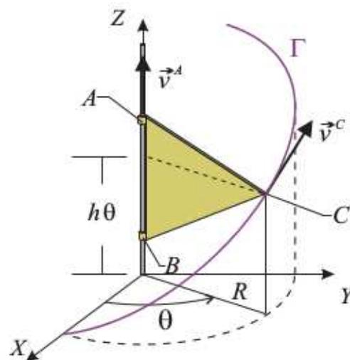
A partir de estos datos calcula el eje de rotación y mínimo deslizamiento, así como la reducción cinemática del movimiento.
