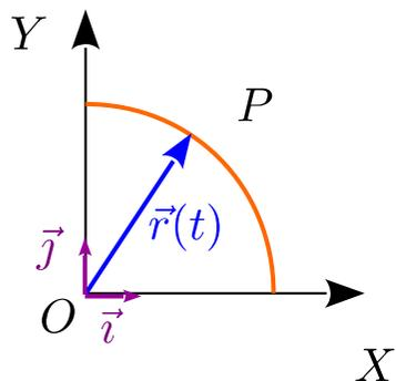
$$\Gamma \equiv \vec{r}(t) = R \cos(\omega t) \vec{i} + R \text{sen}(\omega t) \vec{j} \quad t \in [0, \pi/2\omega]$$
