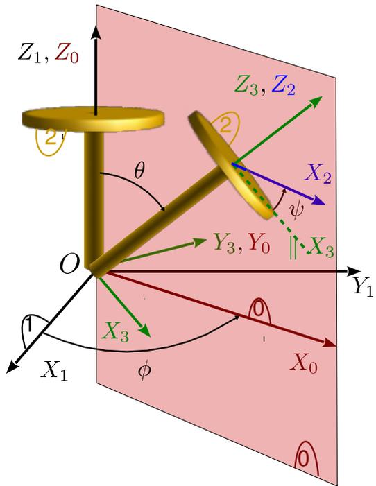
$\phi \rightarrow$  Rotación alrededor del eje  $Z_1: 1 \rightarrow 0$       $\vec{\omega}_{01} = \dot{\phi} \vec{k}_{0,1}$
