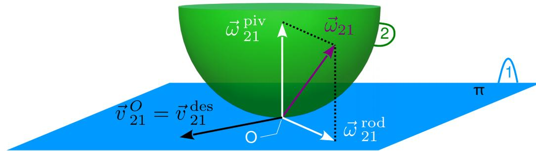
$\vec{\omega}_{21}^{\text{rod}}$  **rodadura**: es la componente de la rotación paralela al plano  $\pi$
