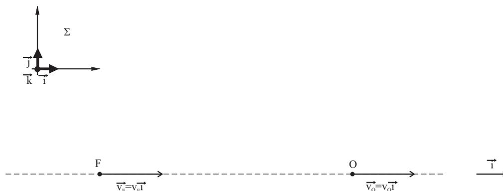
Figura 7.14: Esquema básico para analizar el efecto Doppler. Trabajaremos en el plano que contiene a la fuente y al observador, y por simplicidad consideraremos que  $F$  y  $O$  se mueven según la línea que los une. El vector unitario  $\vec{i}$  del sistema de referencia ligado al medio se ha tomado paralelo a dicha dirección y en el sentido que va de la fuente al observador.
